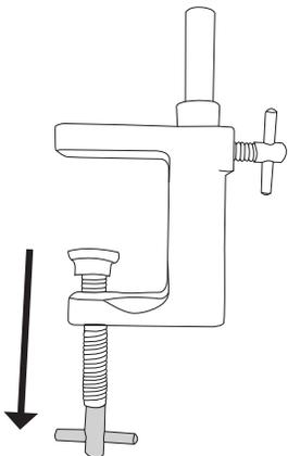
2. Positionieren Sie die geöffnete C-Klemme an einem Tisch oder einer anderen stabilen Oberfläche.
