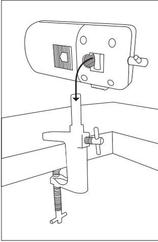
2. Drehen Sie die T-Schraube an der Lupe, um diese wie unten gezeigt an der C-Klemme zu befestigen. Die Lupe kann um 360 Grad gedreht werden.
