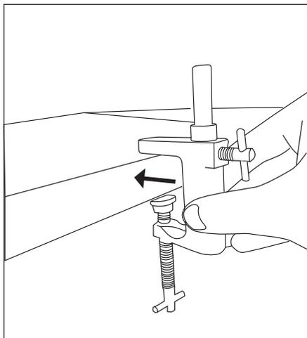
3. Ziehen Sie die T-Schraube an, um die Klemme in der richtigen Position zu fixieren.
