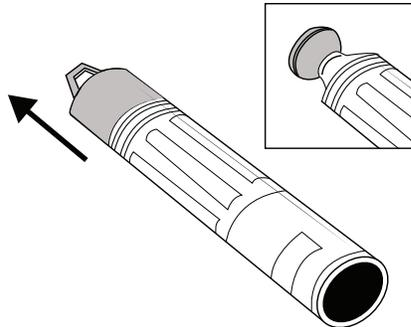
3. Setzen Sie die Kappe wieder auf und drehen Sie sie einmal, um die Spitze mit Reinigungsmittel aufzufüllen.
