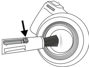
2. Nehmen Sie die Kappe ab und reinigen Sie die Linse in kreisenden Bewegungen.
