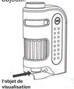
2. Appuyez sur l'interrupteur LED pour allumer et éteindre – pour la fin de l'observation.
