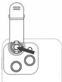
2. Fixez le clip adaptateur en haut du microscope et allumez votre caméra. Si l'image n'est pas centrée ou si elle n'est pas complètement ronde, ajustez le clip adaptateur pour vérifier qu'il est bien centré par rapport à la caméra.
