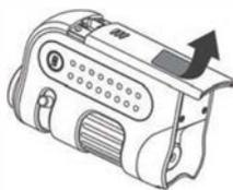
2. Insérer une pile AA en respectant la polarité et remettre le couvercle en place.
