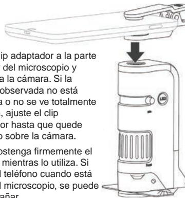
Fije el clip adaptador a la parte superior del microscopio y encienda la cámara. Si la imagen observada no está centrada o no se ve totalmente redonda, ajuste el clip adaptador hasta que quede centrado sobre la cámara.
