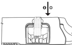
3. Schließen Sie den Batteriefachdeckel und schrauben Sie ihn mit einem Schraubendreher fest.
