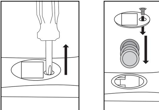
**ADVERTENCIA:** Pilas: La mezcla de pilas viejas y nuevas, de diferentes marcas o de tipos dentro de una misma marca puede hacer que las pilas tengan fugas, se sobrecalienten o exploten. Manténgalas alejadas del fuego o del calor excesivo. Inspeccione las baterías en busca de corrosión o fugas. Insértelas en la dirección indicada. Deseche las pilas de botón con cuidado. Mantenga las pilas de botón fuera del alcance de los niños.
